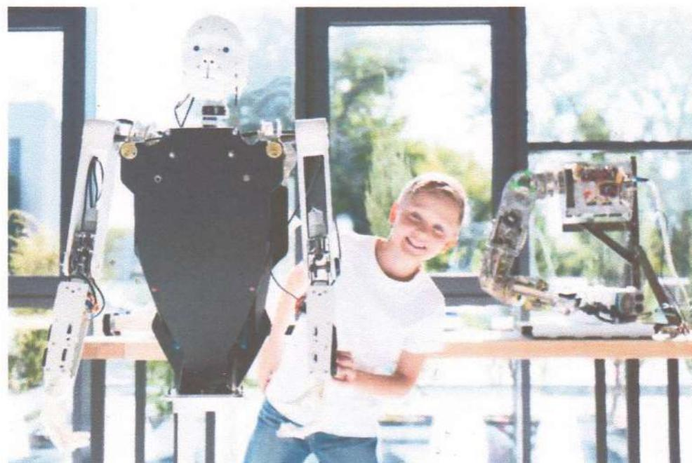
Це захоплюючий робот, який порадує як дорослих так юних інженерів. Це справжній робот гуманоїд. Цей робот частково виготовляється на 3Д принтері, частково на верстаті з ЧПК, частину ви виготовите зі школолярами за допомогою ручного інструменту. Тільки уявіть, на занятті вчитель зі школолярами виготовляють робота гуманоїда, а потім програмують його, надихають життям, розробляють для нього штучний інтелект та технічний зір, навчають його та із задоволенням ходять до школи.
